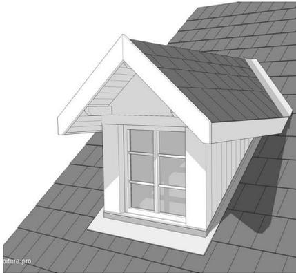
Figure 3 - Lucarne de type jacobine (source : toiture.pro)
